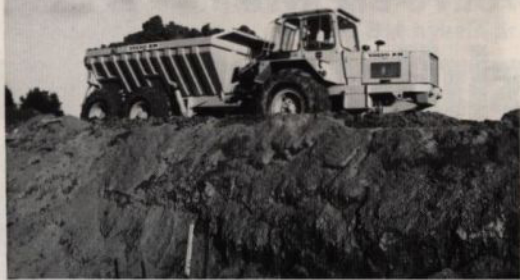
Dumper VOLVO BM 860 har blivit en allt vanligare syn i mer eller mindre "väglösa" transporter. Därmed har den kommit att utgöra ett värdefullt komplement till lastbilarna. I sitt nyaste utförande med Lock-up-anordning ökar dumpers effektivitet ännu mer.
