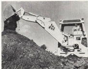
Samtliga hydraulkolvar har samma diameter. Härigenom kan samma tätningar användas överallt.
