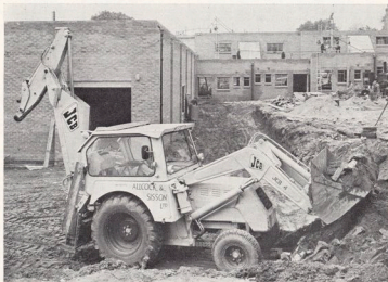
Frontskopan har en brytkraft på 4,7 ton, vilket gör den till ett effektivt arbetsredskap. I terräng som annars är oframkomlig kan frontskopan användas för att bryta fram maskinen.
