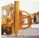
Säkerhetskoppling för hyvelbladets svängfunktion.
