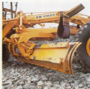
Hydraulisk skärvinkeinställning. Vitala stötdelar utbytbars.
