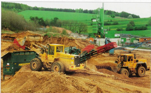
En ny hjullastare Volvo BM L120B med 3,1 m 3 skopa arbetar i Schwallunger sandtaget tillsammans med en ett år gammal föregångare Volvo BM L120. Den gemensamma lastkapaciteten uppgår därmed till omkring 2000 m 3 .
