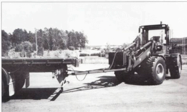
Bogsering av hjullastare efter lastbil. En bogseringsteknik som har arbetats fram av VME tillsammans med Försvarets Materielverk. En anordning som kanske även kan vara av intresse för många entreprenörer.
