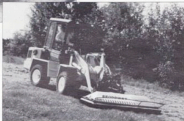
Zettelmeyer's hjullastare kan köras extremt försiktigt på gräsmattor med differentialspårren urkopplad. Med klippaggregatet RK-2, som är en rotorklippare, får man en effektiv skärbredd på hela 2 meter.
