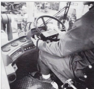
Contronic-systemet minimerar tiden för felsökning genom att direkt ange felkällans läge. Mera detaljerad information om maskinens aktuella status finns i en särskild informationspanel för servicepersonalens behov.
