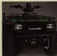
Kylaren sitter inbyggd bakom en kraftig galler och är väl skyddad mot sten och andra destruktiva föremål.
