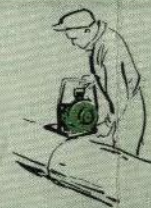
Kundkap underlättas betydligt av det kraftigt utformade barkstödet
