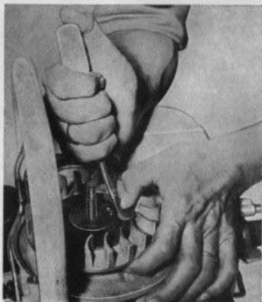
Fig 26. Gummiplatta för brytarspetsarnas inspektionshål monteras på svänghjulet
