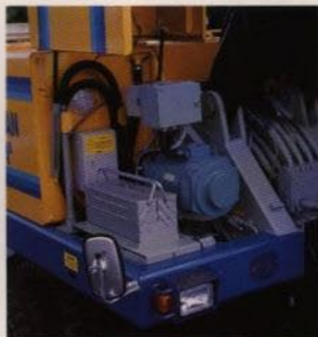
Generatorinstallation för drivning av lyftmagnet.
