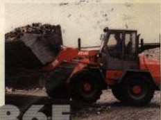
86E Gewicht / Weight: ..... 6,7t Leistung: / Power: ..... 61 kW Schaufel: / Shovel: ..... 1,3 m 3
