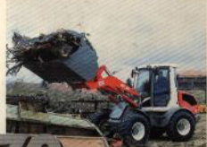
70 Gewicht / Weight: ..... 5,9t Leistung: / Power: ..... 48,5kW Schaufel: / Shovel: ..... 1,0 m 3
