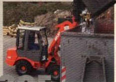
32E Gewicht / Weight: ..... 2,5t Leistung: / Power: ..... 22kW Schaufel: / Shovel: ..... 0,35 m 3
