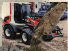
80 Gewicht / Weight: ..... 6,1t Leistung: / Power: ..... 51,5 kW Schaufel: / Shovel: ..... 1,0 m 3
