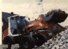
55 Gewicht / Weight: ..... 4,5t Leistung: / Power: ..... 39kW Schaufel: / Shovel: ..... 0,8 m 3
