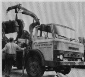
Kraftiga axlar gör den lämplig som kranbil. Frambyggd tippbar hytt förenklar servicen. Tippar hytten, och motorn ligger helt fri och i arbetsbänks höjd.
