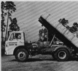
Som tippbil med 7 tons lastkapacitet.
