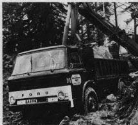
Kraftiga och robusta lastvagnar med hög lastförmåga. 6-cyl. dieselmotor på 128 hk SAE.
