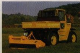
Bakmonterad slaghack Epoke GM20.
