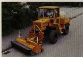
Vattentank och frontmonterad sopvals.
