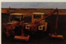
Mittmonterad slaghack Epoke UH60 och frontmonterad Epoke UH35.
