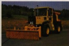
Frontmonterad sopvals Epoke FM23 och flakspridare Epoke P10.
