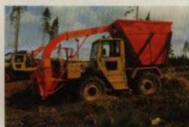
Frontmonterad flistugg och högtippande container på flakutrymmet.
