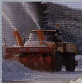
Exempel på högkraftuttagssekt: U 900 med snöslunga i hårt, kontinuerligt snöröjningsarbete.
