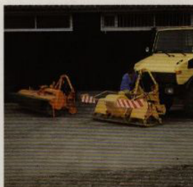
Snabbt redskapsbyte med snabbmonteringsplatta
