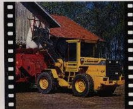
Det stora antalet redskap gör Volvo BM L50B till en av de mångsidigaste maskinerna i sin klass. Här är L50B försedd med ett specialredskap för hantering av storsäck.
