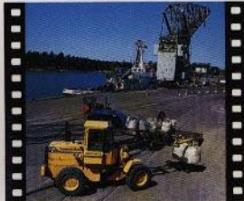
Effektivitet är ett nyckelord för nya Volvo BM L50B. Du förflyttar dig snabbt mellan olika arbetsplatser i ex inom ett hamnområde. Och tack vare det stora antalet redskap och hydrauliskt redskapsfäste kan L50B utföra många olika arbetsuppgifter.
