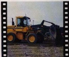
En vanlig uppgift för Volvo BM L50 B är planeringsarbete. Skopan kan tiltas mer än 90° framåt, vilket gör det möjligt att planera effektivt i båda riktningarna. Med hjälp av tilt-rörelsen kan du också dra loss maskinen om du kör fast.
