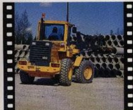
Genom den stora, välvda och djupt neddragna framrutan ser du redskapet, hjulen och motvikten tydligt. Du har god kontroll över både maskinen och omgivningen och kan arbeta effektivt även i trånga lägen.
