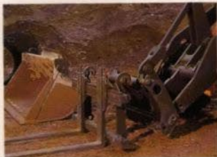
Tack vare det hydrauliska redskapsflöjet kan du ansluta Volvo BM originalredskap på några sekunder.
