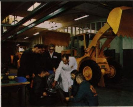
Alla moment i mekanikerarbetet är baserade på arbetsstudier. Här går man igenom monteringsgången på transmissionen till en Parca-lastare.
