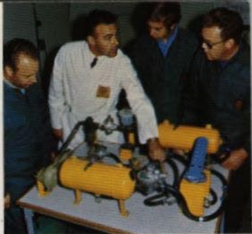
Felsökning är en annan väsentlig del i mekanikerutbildningen. På denna modell av en bromsansordning kan en rad knepiga fel simuleras.
