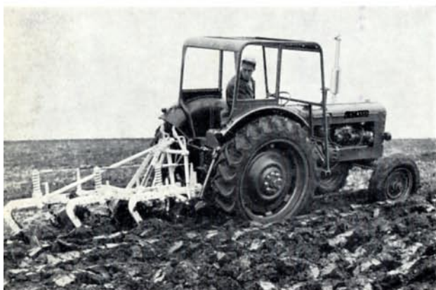
350 i jordbruket ger stor avverkningsgrad till låga kostnader. Den har rätt tyngd i förhållande till effekten och den är väl avbalanserad. De stora hjulen och differentialspärren ger mindre slirning — lägre bränsleförbrukning.
