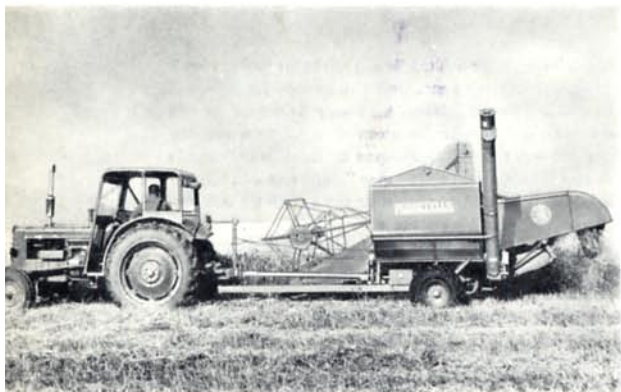
350 har mer än nog styrka för en 6-fots skördetröska. Centrifugalregulatorn håller varvtalet jämnt vid olika belastningar i alla situationer. Det oberoende kraftuttaget ger större avverkningsgrad och driftsäkerhet.
