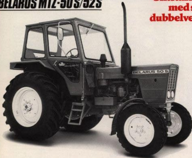
BELARUS MTZ-50S/52S har en 4-cylindrig motor på 4,75 liter och 65 hk (DIN). Tjänstevikten är 3.390/3.640 kg.
