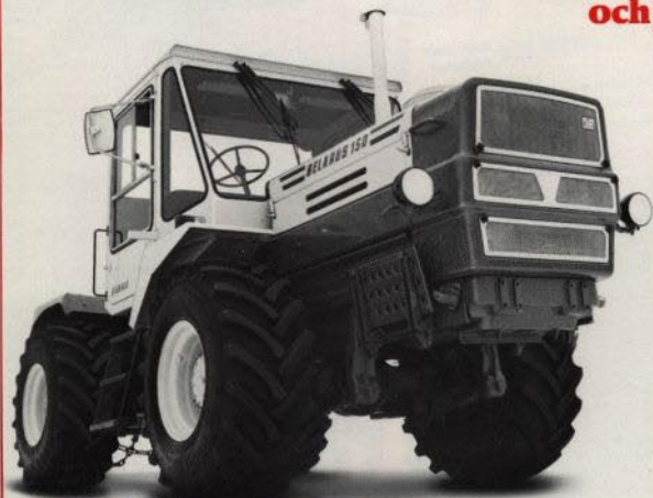
BELARUS T-150-K har en 6-cylindrig motor på 9,15 liter och 175 hk (DIN). Tjänstevikten är 8.480 kg.
