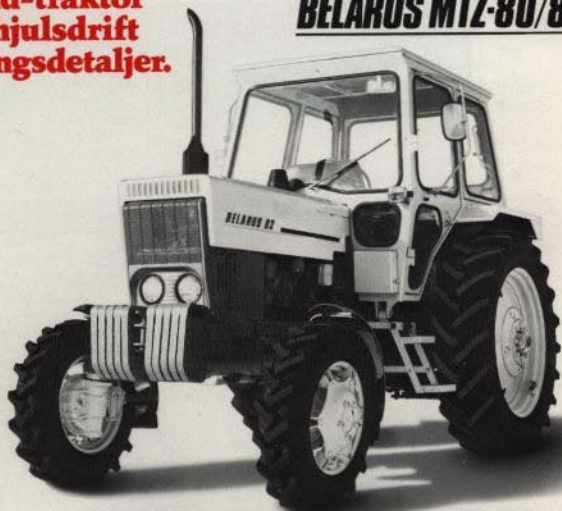
BELARUS MTZ-80/82 har en 4-cylindrig motor på 4,75 liter och 80 hk (DIN). Tjänstevikten är 3.600/3.840 kg.
