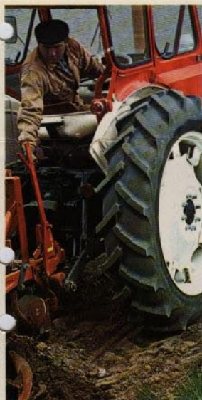
Modellerna 990 och 880 har dragstänger och tryckstång för redskap i kategori I och II. Modell 1200 endast för kategori II.
