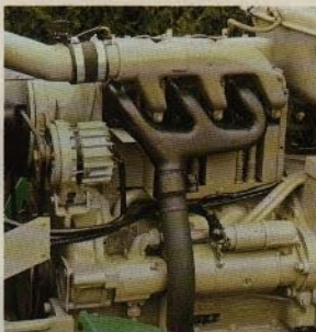
DEUTZ luftkyld motor F3L 912
