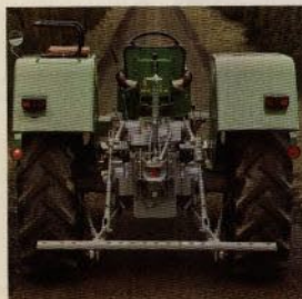
Här den hydrauliska lyftanordningen och traktorns bakparti.
