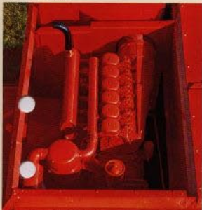
6-cyl 90 hk luftkyld DEUTZ motor
