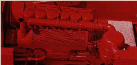
Stark, luftkyld DEUTZ dieselmotor
