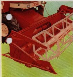
Hydraulisk horisontellinställning av haspel
