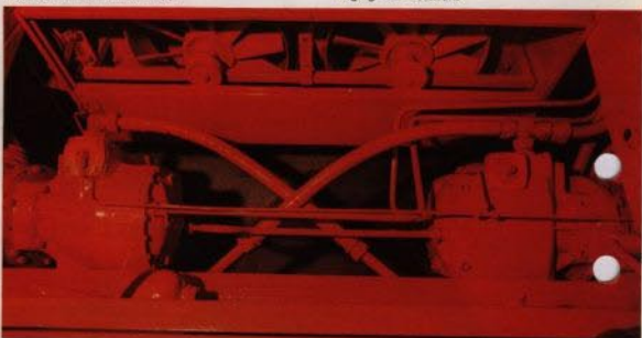
Hydraulmotorer för hydrostatisk drivning. Axialfläktar för rensluften
