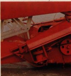
Planetdrivning för kniven
