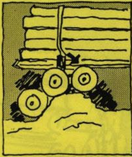
3. Det mittersta hjulet har svängt över det främre och vagnen kan fortsätta.
