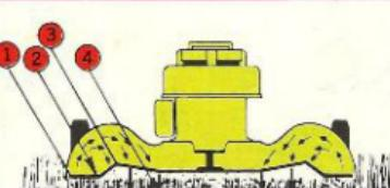
**EXKLUSIV AERODYNAMISK ORBITKAMMARE** — (1) Gräset klipps med det patenterade mångböjda rotorbladet (2). Bladet framkallar uppstående drag och drar klippet in i orbitkammaren, där (3) det cirkulerar och återcirkuleras tills det är fint nog att (4) blåsas nedåt, går förbi bladet och försvinner djupt in i matten som en fuktbevarande mull.
