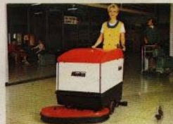
Batteridrivna skurautomat. Arbetsbredd 70 eller 85 cm för stora ytor inom industrin, sjukhus, sporthallar etc.
