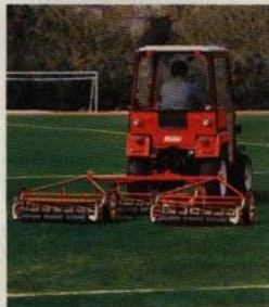
Cylindersklippare med 225 cm arbetsbredd.
