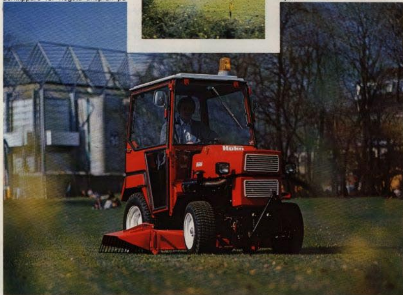
Rotorklippare med 150 cm arbetsbredd.
