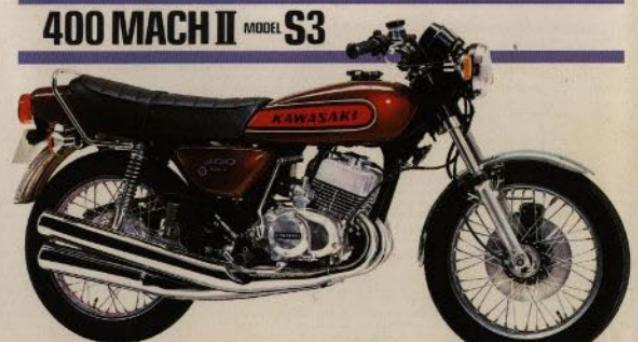
400 cc 3-cyl. 2-taktsmotor • 42 hk/7.000 varv • Vridmoment 4,32 kg–m/6.500 varv • Kvartsmilen på 13,8 sek. • Over 175 km/tim. • Motorn gummiupphängd • Hydr. skivbroms • Vikt 159 kg • Hjälmkrokar, reservstiftshållare • Mätare för brombsbandtjockleken • Ny instrumentpanel med indikationslampor • Låsbar sadel • Superlube-smörsystem • Färg: Röd-metallic
