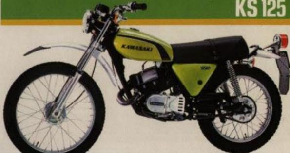
125 cc slidmatad 1-cylindrige 2-taktsmotor • 13 hk/7.000 varv • 6-växlad • SUPERLUBE-smörjsystem • 21" hjul fram • Aluminiumcylinder • Vikt 97,5 kg • Låsbar sadel och tanklock • Hjälmkrok • 0–201 m på 11,1 sek. • Färg: Racing grön
