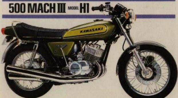
500 cc 3-cyl. 2-taktsmotor • 59 hk/8.000 varv • Kvartsmilen på 12,4 sek. • 200 km/tim. • Vikt 185 kg • CDI-transistorlämpning • Motorn gummiupphängd • Nytt oil pick-up system ger bättre kylining av lager samt inte minst tystare gång • Låsbar sadel, hjälmkrok, reservstiftshållare, hydraulisk styrdämpare • Färg: Grön-metallic
