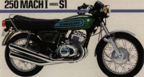
250 cc 3-cyl. 2-taktsmotor • 28 hk/7.500 varv • 160 km/tim. • 0–100 km på 6 sek. • Vikt 150 kg • 5-växlad • SUPERLUBE-smörjsystem • Ny instrumentpanel • Hjälmkrok, reservtändstiftshållare • Låsbar sadel och tanklock • Färg: Grön-metallisk
