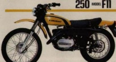
250 cc 1-cylindrige 2-taktsmotor • 23,5 hk/6.000 varv • 5-växlad • INJECTOBULE-smörjsystem • Vridmoment 2,81 kg-m/5.000 varv • 0–402 m på 16 sek. • Vikt 120 kg • Färg: gul
