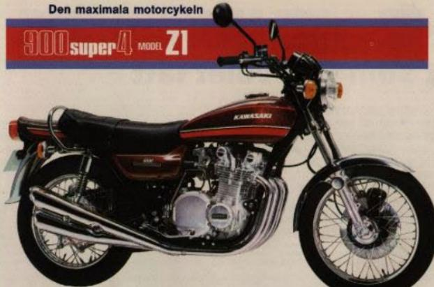
900 cc, 4-cylindrig 4-taktsmotor med dubbla överliggande kamaxlar (DOHC) • 82 hk/8.500 varv • 5-växlad • Över 200 km/tim. • Avgasrenning • El-start • Vätsump • Från stående start till 402 m (kvartsmil) på 12 sekunder • Färger: brun/orange metallic – grön/guld metallic
