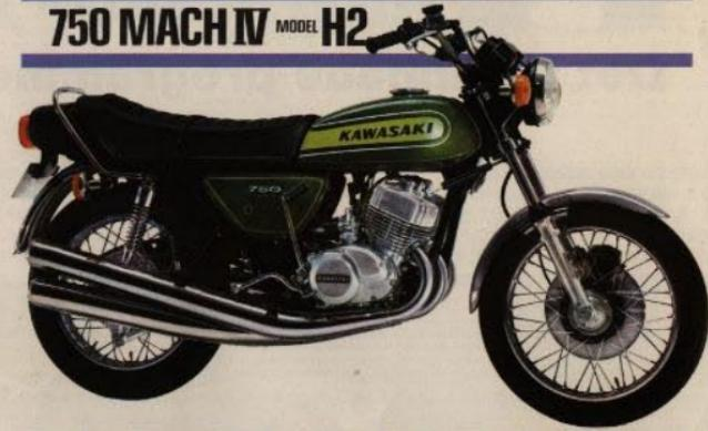
750 cc 3-cyl. 2-taktsmotor • 71 hk/6.800 varv • Vridmoment 7,9 kg–m/6.500 varv • Kvartsmilen på 12,0 sek. • 203 km/tim. • Gummiupphängd motor • Nytt oil pick-up system för bättre smörjning och kylining av lager • 50 mm längre hjulbas • CDI-transistorlämpning • Hydr. skivbroms och styrdämpare • Låsbar sadel och tanklock • Färg: Grön-metallic
