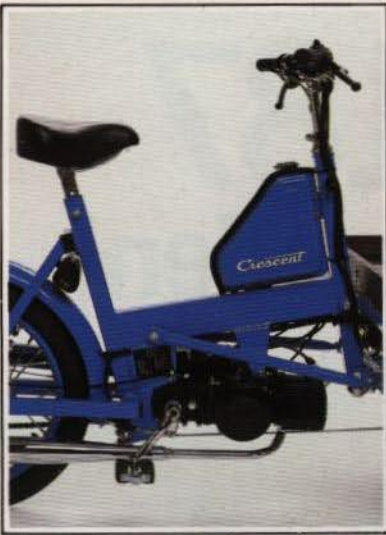
Ny ramkonstruktion helt baserad på fyrkantör Ny bensintank
