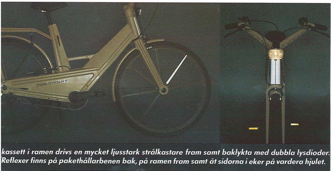
Vid cykling står människans kropp för ca 90% av luftmotståndet, cykeln för ca 10%. Itera cykelns aerodynamiska utformning har testats fram i bl.a. Volvos vindtunnel. Din egen kan bara du själv göra något åt.
