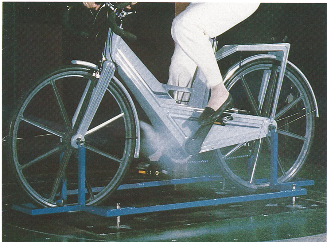
Vid cykling står människans kropp för ca 90% av luftmotståndet, cykeln för ca 10%. Itera cykelns aerodynamiska utformning har testats fram i bl.a. Volvos vindtunnel. Din egen kan bara du själv göra något åt.
