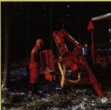
Kvistningsknivarna är nedtitlade och vinschen har dragit stammen till bordet. Processorn står stadigt på justerbara teleskopiska stödben.
