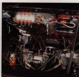
Hytten är tippar och frilägger alla transmissionsdetaljer.
